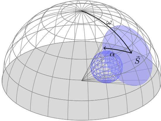
avec  $\alpha$  le demi angle sous lequel est vu la sphère et  $\omega$  l'angle entre la vertical (normale à la surface sur laquelle se projettent les ombres) et la direction de la sphère.
